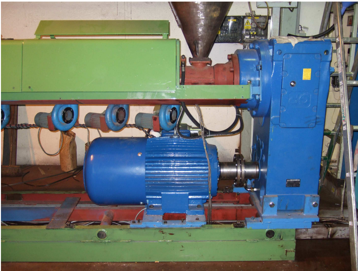
Obr.1: Pohon extrudéru 55kW s převodovkou.
